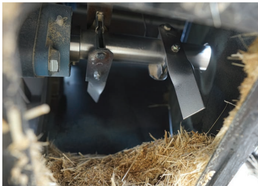
Internal fan blades on the Weedhog.
